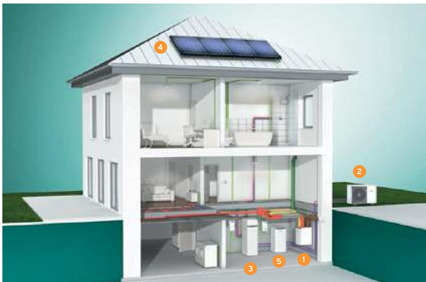
Gesunde Luft und Wohlbefinden zu jeder Jahreszeit: Unsere Wohnraumlüftung recoVAIR ermöglicht dies in jeder Systemkombination mit durchschnittlichen Energieeinsparungen von bis zu 30%. Für Neubau und Modernisierung ist sie die perfekte Systemergänzung für unsere Wärmeerzeuger – denn bei uns erhalten Sie alle Komponenten aus einer Hand.
